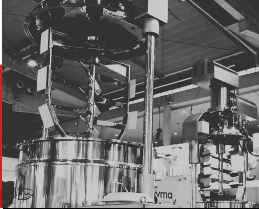
Los agitadores se utilizan para mezclar líquidos o suspensiones y evitar la sedimentación, asegurando que los componentes se distribuyan uniformemente. La tarea principal de un agitador es generar turbulencia en el líquido, no moverlo de un lugar a otro como lo hace la bomba.
